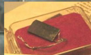
Teilmodul bestehend aus 9 Si Solarzellen als „Sonnenbatterie“ bezeichnet im Schutzgehäuse mit Ölfüllung (Bell Telephone Lab.)
